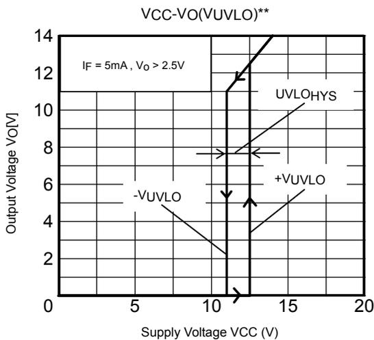
\*\*Test Circuit : V<sub>CC</sub>-V<sub>O</sub>(V<sub>UVLO</sub>)
