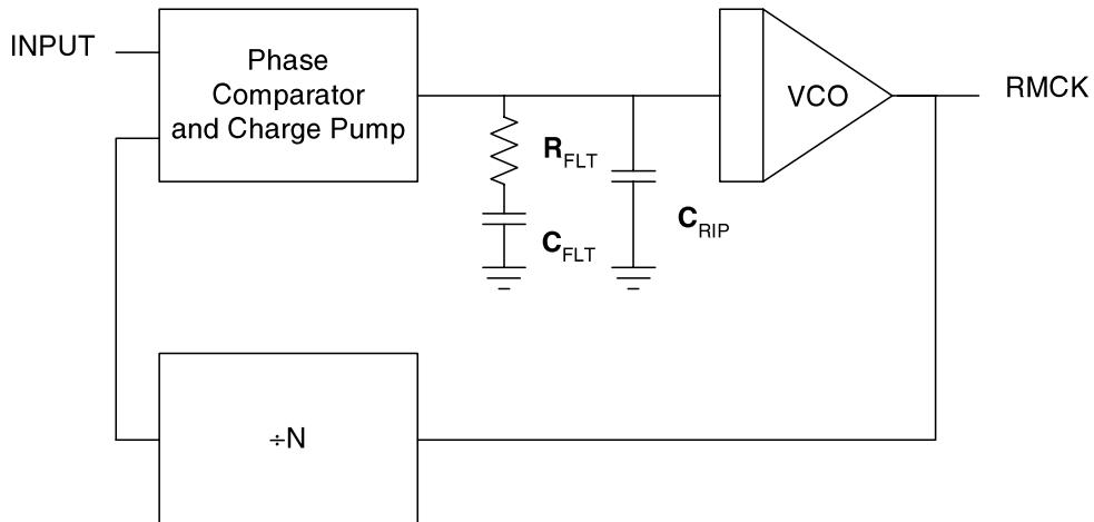
**Figure 23. PLL Block Diagram**
